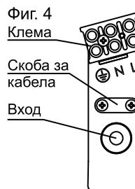
"Beta 7" - свързването се извършва с помощта на трижилен кабел, директно свързан в уреда към колонковата клема. Фазовият проводник се свързва с колонката, маркирана със знака за защитно свързване. Проводниците на захранващия кабел трябва да бъдат със сечение най-малко  $4 \text{ mm}^2$ , а предпазителят във фазовия кръг - 35 A.
